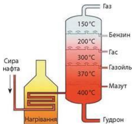
Мал. 29.2. Схема перегонки нафти в ректифікаційній колоні
