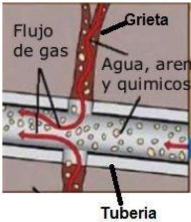
Los hidrocarburos asciendan a la superficie junto con parte de la mezcla inyectada, denominada reflujo (se recupera una cantidad que varía entre un 9 y un 35%). El resto se queda en el subsuelo.
