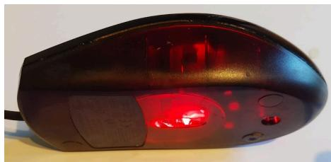
remplacées par les souris optiques (à lumière). Souris où la boule est remplacée par une diode laser. La technologie utilisée est basée sur : d'un côté un émetteur (une diode laser) qui envoie des impulsions lumineuses à une fréquence donnée et de l'autre un capteur qui réceptionne ces impulsions après qu'elles se soient réfléchies sur le support. Plus la fréquence d'émission est élevée et plus la souris est censée être précise.
