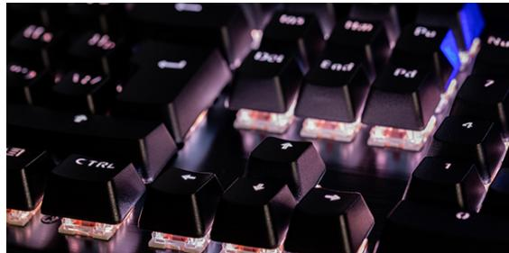
Il est davantage destiné aux gamers et gameuses. La différence majeure entre un clavier membrane et un mécanique est la présence de **switchs** sur le second. Et non, on ne parle pas de la console Nintendo ! Quand on parle de switch, on désigne en fait **l'interrupteur qui est placé sous chaque touche du clavier**. Ainsi, quand vous appuyez sur une touche, elle entre en contact avec cet
