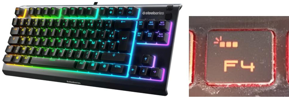
Certains claviers ont un éclairage par l'arrière des touches, ce qui permet de les utiliser dans la pénombre. Les gamers aiment l'effet arc-en-ciel, mais on peut gérer la couleur et les zones d'affichage grâce au driver du constructeur. Une touche de fonction permet la commande. On peut régler la proportion des couleurs RGB : Red (rouge), Green (vert), Blue (bleu).
