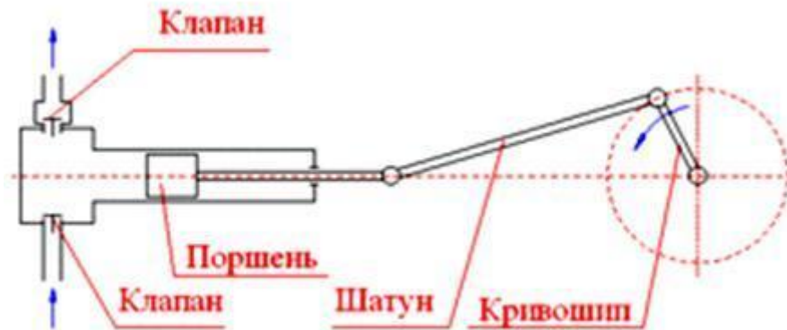
Рис. 1. Конструктивна схема найпростішого поршневого насоса односторонньої дії.
