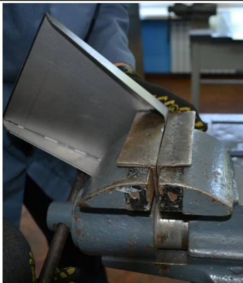
10. Встановлюємо заготовку в тиси, щоб загнути бокові частини совка
