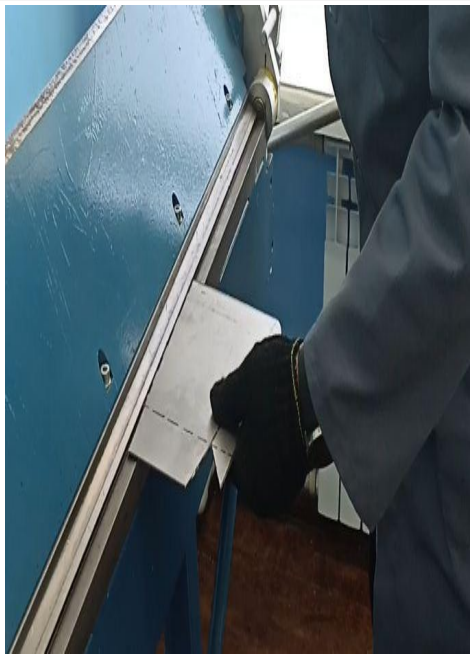
7. Встановлюємо заготовку з кресленням в станок згинання листового металу
