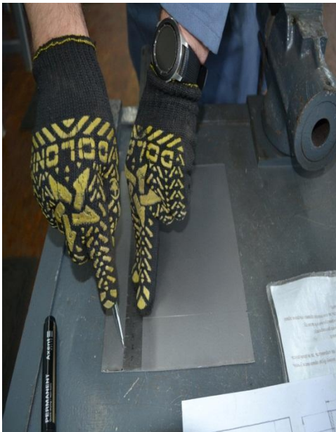
4. Переносимо малюнок на заготовку металу (совка) відповідно кресленню
