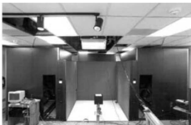
Figura 3.4 Desenho conceitual de uma CAVE (esquerda). Os usuários ficam cercados de imagens estereoscópicas com perspectiva correta exibidas no chão e nas paredes com as quais eles interagem. O CABANA (à direita) tem paredes móveis para que o monitor possa ser configurado em diferentes formas de exibição, como uma parede ou um formato em L. (De Cruz et al. [1992] (esquerda) e Daily et al. [1999] (direita))
