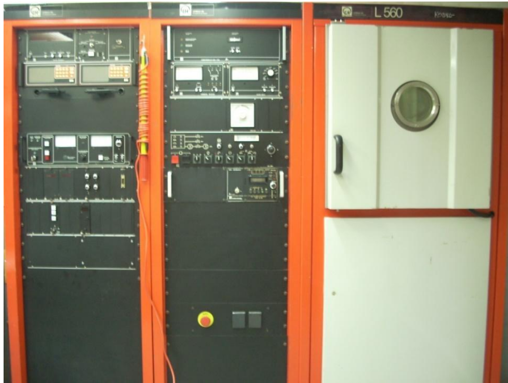
Рис. 2.1 Універсальна вакуумна установка Leybold-Heraeus L560
