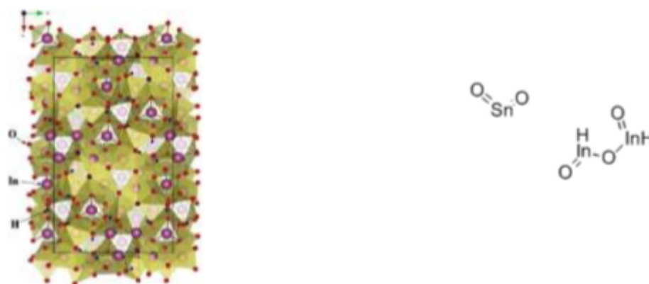
Рис. 1.11 Структура ІТО (хімічні формули - молекулярна та емпірична)
