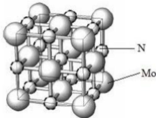
Рис. 1.5 - Кристалічна структура \gamma\text{ Mo}_2\text{N} .
