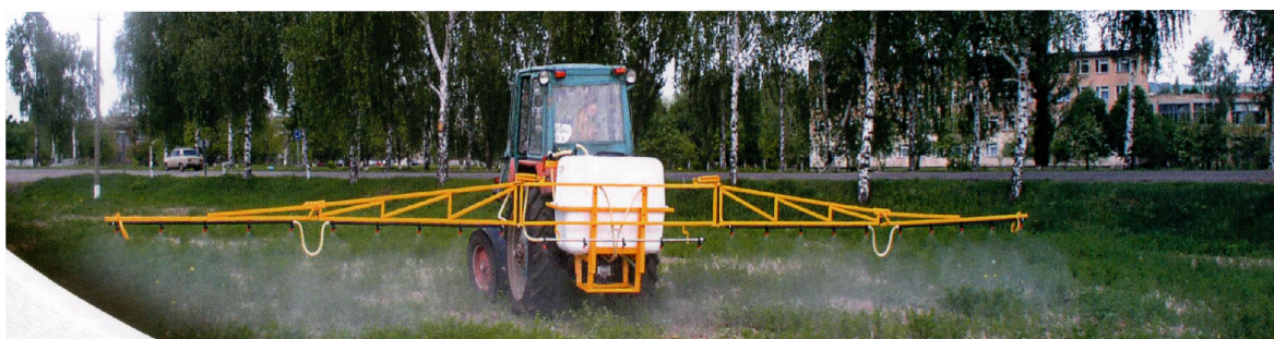
Рис 87 Начіпний штанговий обприскувач ЕКО-600-12
