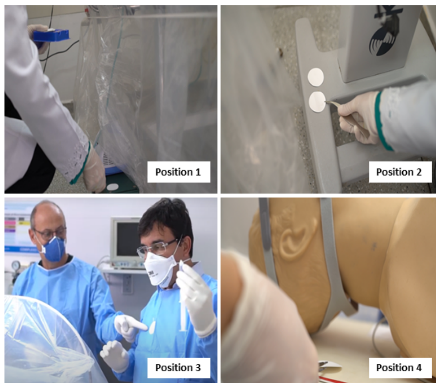
Fig. 1 Posicionamento dos sensores de nitrocelulose para monitoramento de contaminação
