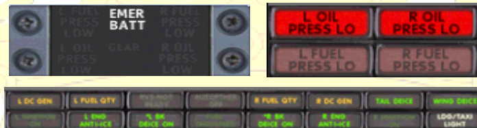
Figura 3: Testigos de funcionamiento sistemas.
