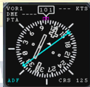
Figura 1: Indicador de Situación Horizontal (HSI).
