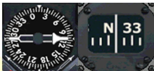
Figura 2: Diferencia entre RMI y la brújula en un giro Este - Norte.
