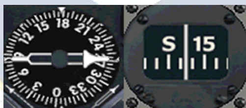
Figura 3: Diferencia entre RMI y la brújula en un giro Este - Sur.
