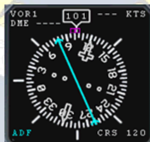
Figura 2: HSI en funciones de ADF.
