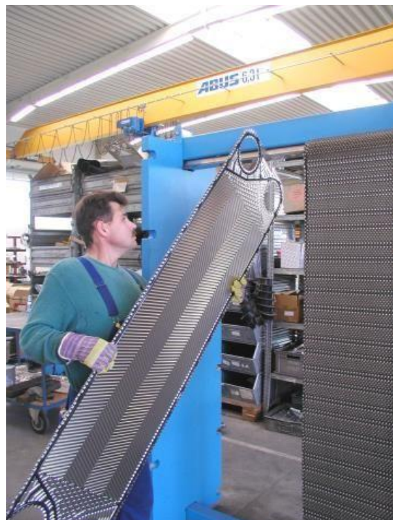
Рис 6.5. Демонтаж пластины с верхней направляющей.
