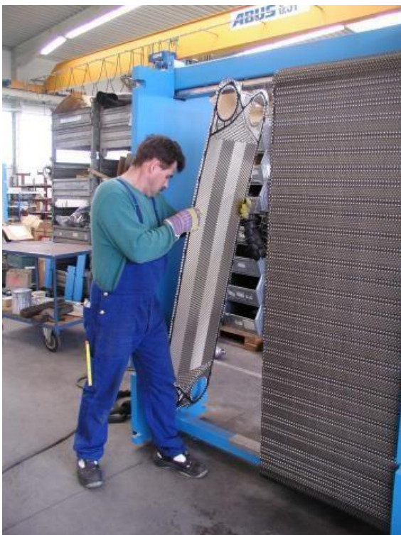
Рис 6.4. Демонтаж пластины с нижней направляющей.
