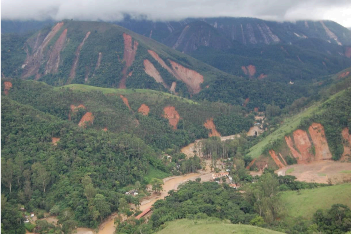
Figura 13 - Nota-se nesta foto que quase todos os deslizamentos tiveram origem em coroas de morro desmatadas, ou em áreas de risco natural, que são áreas com declividade maior que 45 graus.
