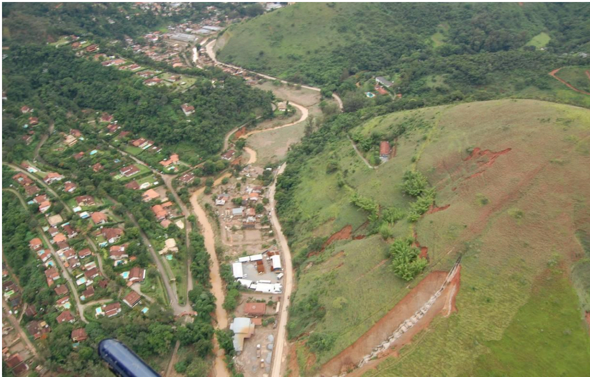
Figura 5 - Ponte do Vale da Lua. Este foto mostra como grandes áreas de pasto degradado canalizam as águas para determinadas valas, iniciando um processo de erosão e pequenos deslizamentos.
