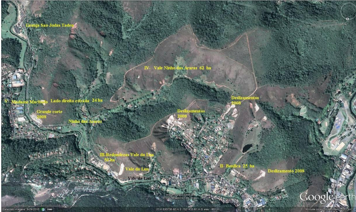
Figura 3 - Benfica e redondezas. Nesta imagem pode ser vista uma série de deslizamentos ocorridos em 2008, em função da área acima dos deslizamentos estarem totalmente desmatada. Área Desmatada: 25 ha
