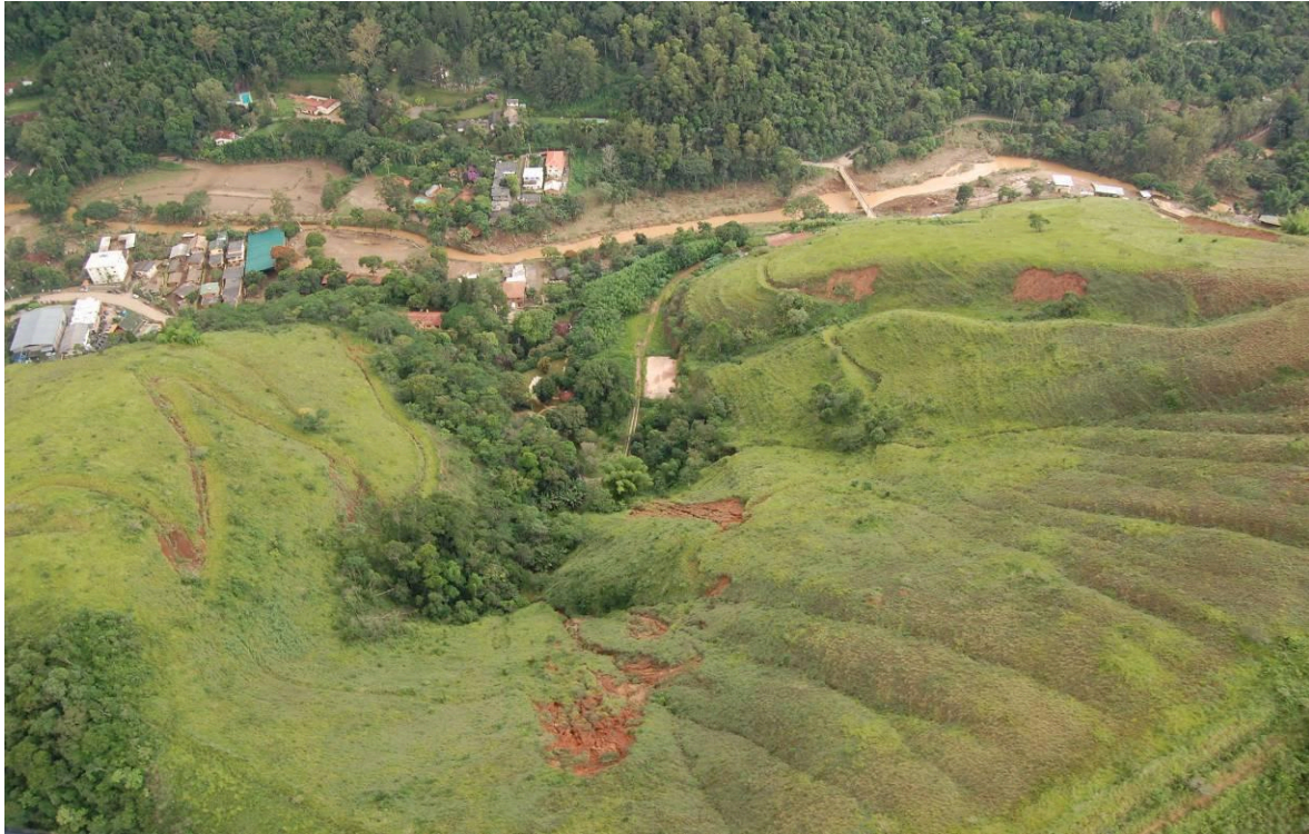
Figura 5 - Ponte do Vale da Lua. Este foto mostra como grandes áreas de pasto degradado canalizam as águas para determinadas valas, iniciando um processo de erosão e pequenos deslizamentos.
