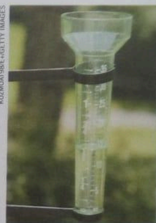
O pluviômetro deve ser instalado em local aberto para que possa coletar a água da chuva.
