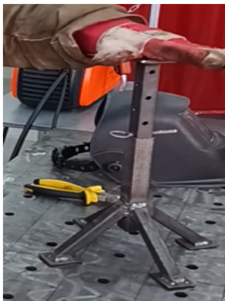
15. Готовий вид страхувальної опори під автомобіль
