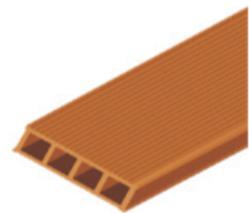
Durante la cottura si hanno possibili deformazioni longitudinali delle tavelle e dei tavelloni. La norma impone un limite a tali deformazioni.
