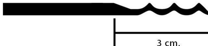
7. Enroscar la varilla sobre su propio eje 90° para darle resistencia ( con cuidado dejando un espacio de algunos milímetros para evitar que el metal se rompa).
