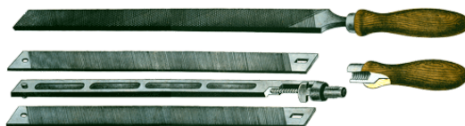
Рис. 1.7.9. Безпечна рукоятка напилків
