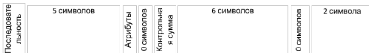
Рис. 4. Формат каталоговой записи с фрагментом длинного имени файла в Windows 98
