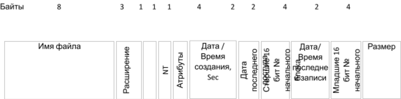
Рис. 3. Формат каталоговой записи в системе Windows 98
