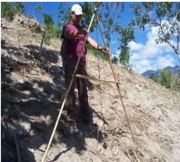
Trazo de curvas a nivel, uso de nivel tipo A
