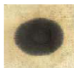
Мал.8 Масло з перегрітого двигуна
