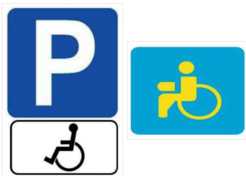
Рисунок 3. Обозначение специального парковочного места для лиц с инвалидностью соответствующими дорожными знаками и разметкой
