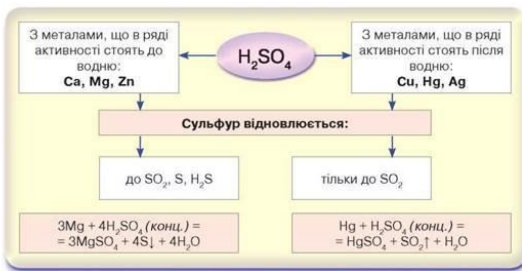
Рис. 41. Схема взаємодії концентрованої сульфатної кислоти з металами
