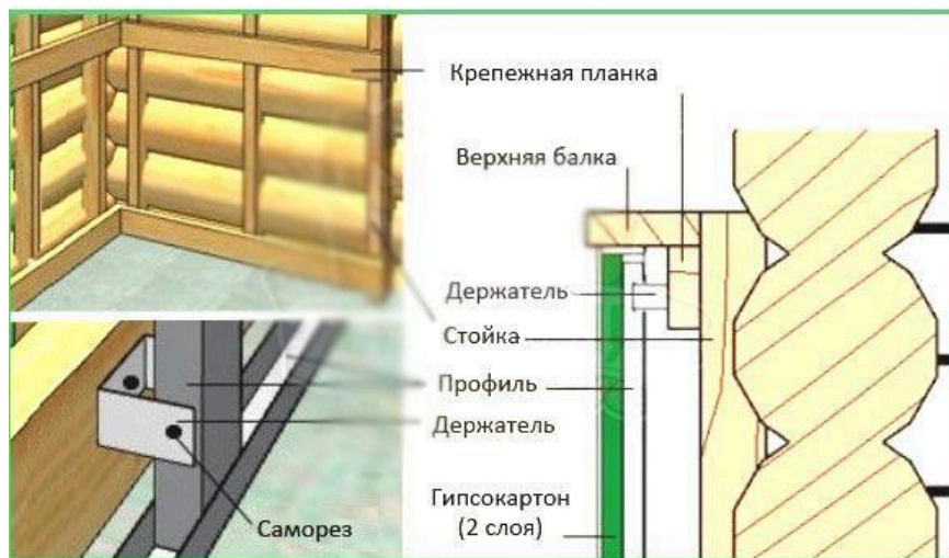
Схема кріплення дерев'яного каркаса до зрубу
