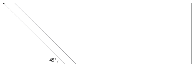
object met hoek groter dan 45^\circ heeft geen support nodig
