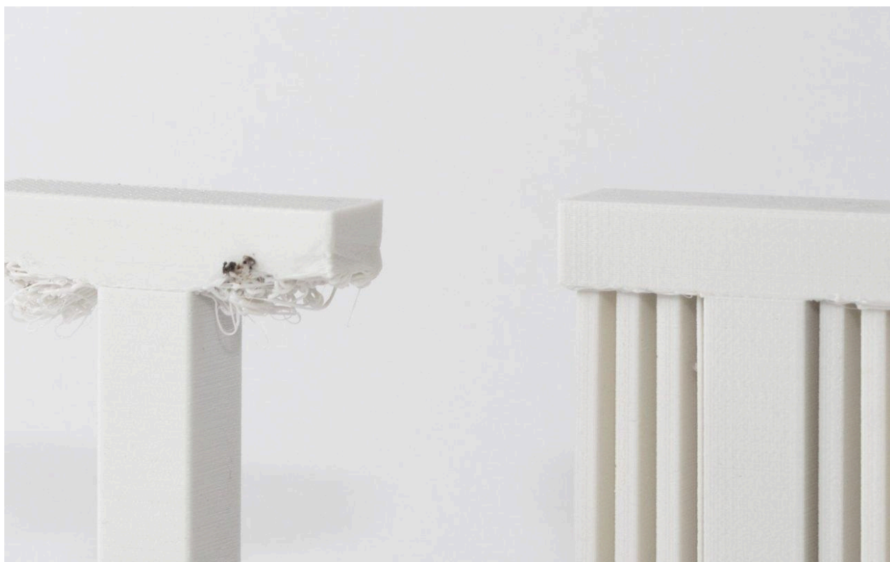
Letter T zonder- (links) en met support geprint
