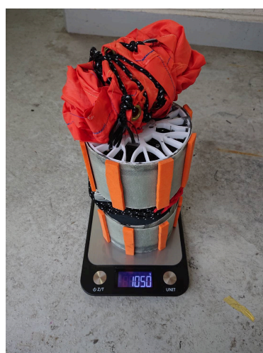
図5.1.1 CanSat本体とパラシュートの合計質量
