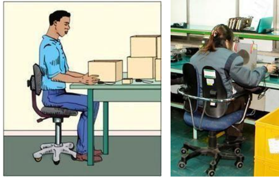
. Sử dụng ghế đôn tạo điều kiện cho người lao động xen kẽ đứng và ngồi
