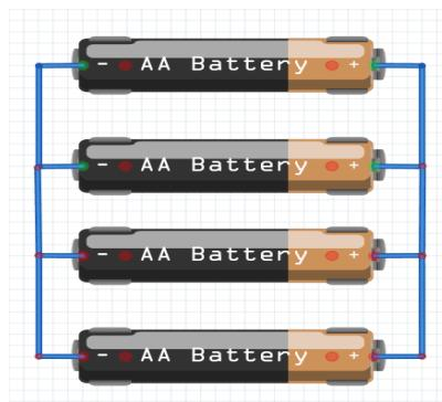
El conjunto de pilas en paralelo ofrece el mismo voltaje que una sola pila: las 4 pilas de 1.5V de la imagen conectadas en paralelo dan 1.5V
