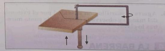
Cuando realices un corte en ángulo has de mantener la segueta en constante movimiento en el punto donde se realiza el giro.
