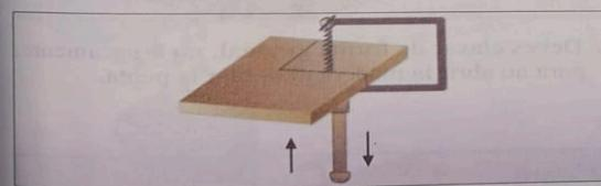
Para cortar en línea recta debes mantener el pelo de la segueta en la posición más perpendicular posible con respecto a la madera.
