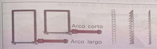
Puedes utilizar arcos cortos y largos, dependiendo de las dimensiones de la pieza que vayáis a cortar.
