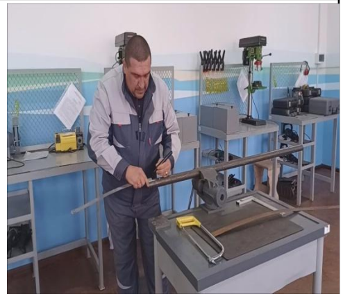
3 За допомогою слюсарно – вимірального інструменту проводимо розмічання труби відповідно креслення
