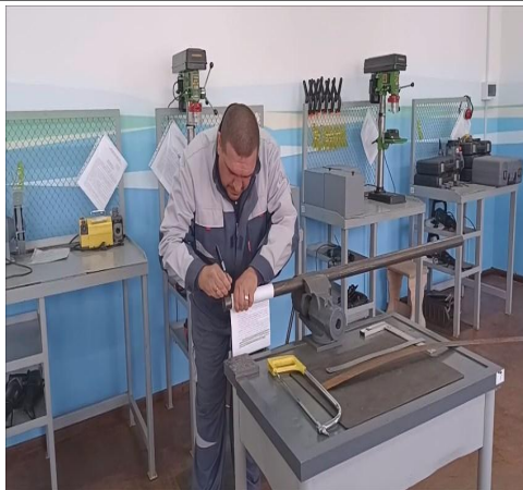
4. Для рівного розмічання труби використовуємо лист паперу
