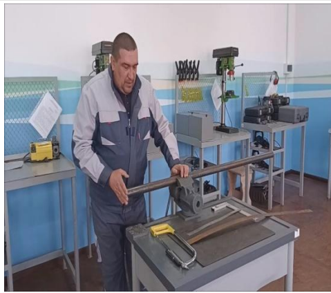
2 Встановлення заготовки труби в слюсарні лещата для подальшого розмічання
