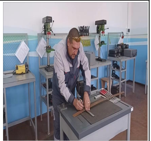
9. Розмічання за допомогою слюсарної лінійки та маркеру
