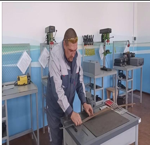
8. Виконую розмічання полоси металу
