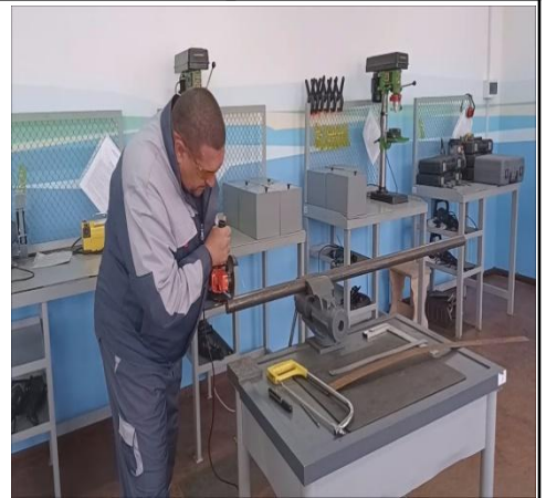
3 За допомогою слюсарно – вимірального інструменту проводимо розмічання труби відповідно креслення
