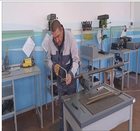
5. Різання труби за допомогою слюсарної ножівки
