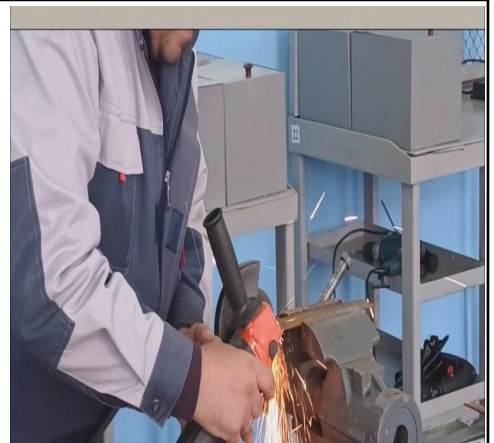
12. За допомогою кутошліфувальної машини вирізаємо напівколо згідно креслення
