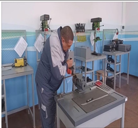
10. Різання полоси за допомогою кутошліфувальної машини
