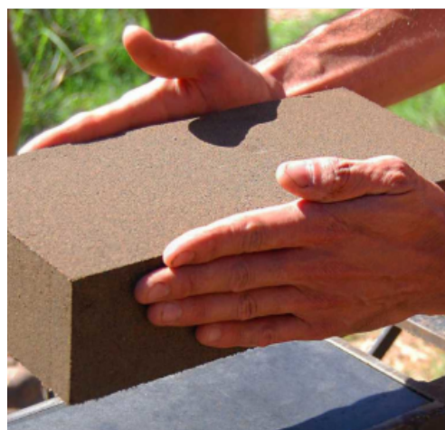
Figura 3. Bloco de terra comprimida (BTC) produzido com uma prensa manual CINVA RAM.
