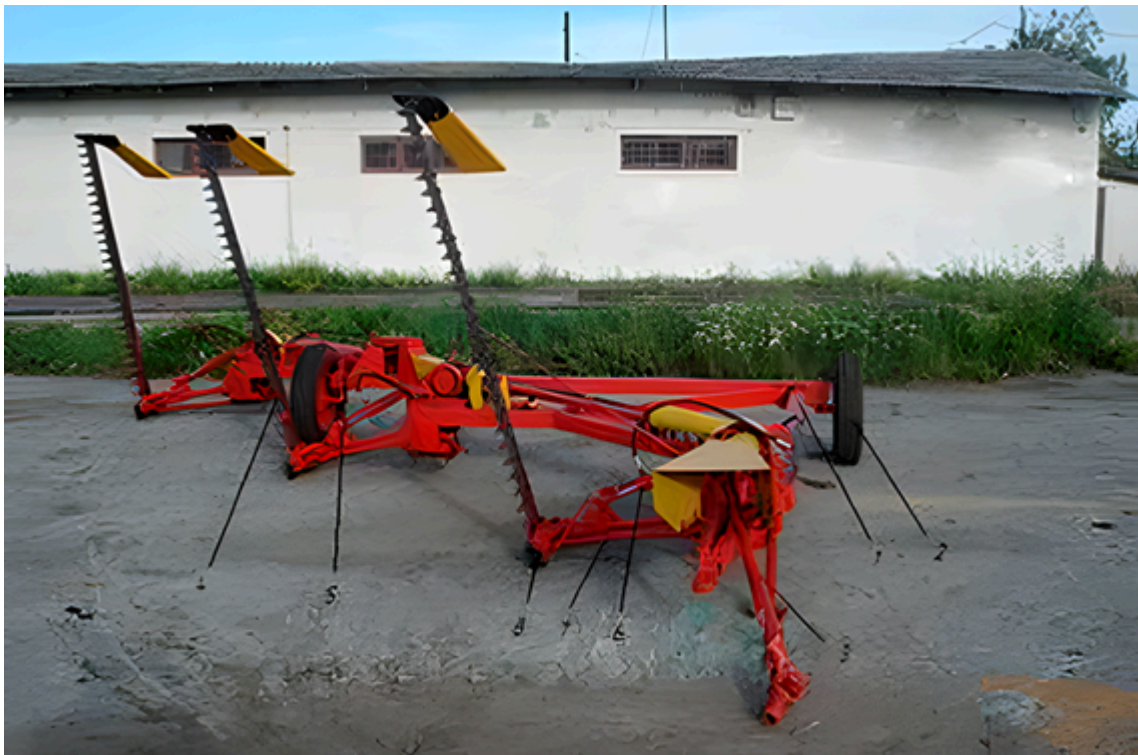
Рис. 5.2.9. Косарка трибрусна причіпна КТП-6:
