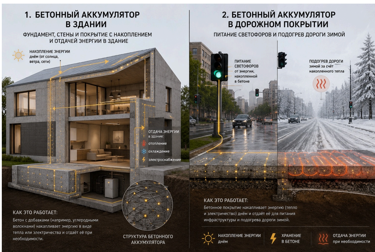
Рис. 3. Концепция интеграция бетонного аккумулятора в городскую инфраструктуру
