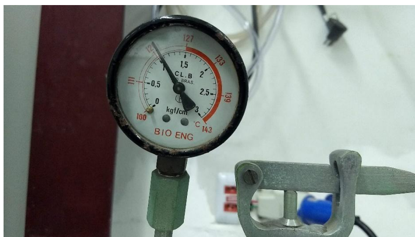
Figura 2 – Manômetro (parte externa com indicação da temperatura e parte interna com indicação da pressão)
