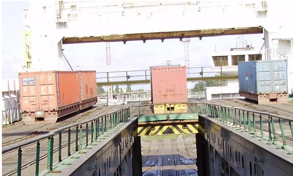
Рисунок 1 – Розміщення рол-трейлерів на верхній палубі залізничного порому «Грейфсвальд»
