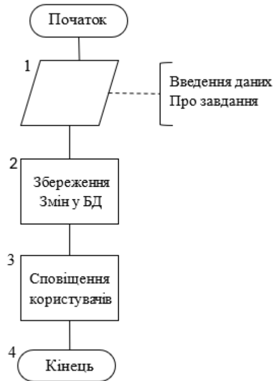
Рисунок 2.15 Блок-схема функції «Керування завданнями»
