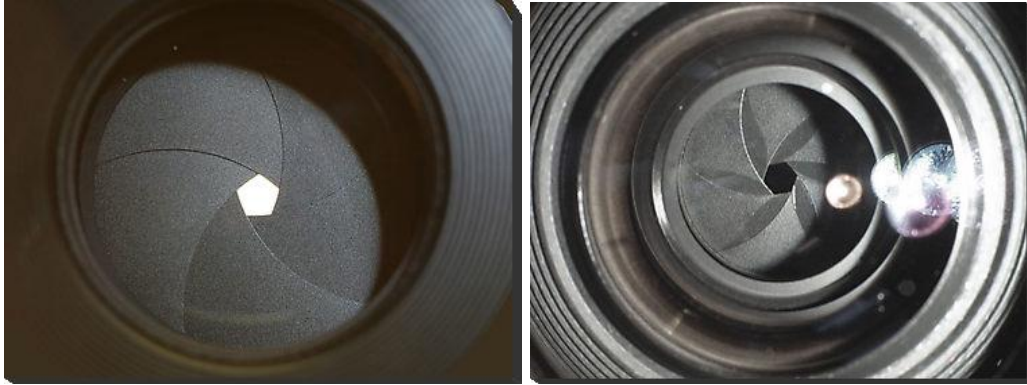
A la izquierda un diafragma en perfecto estado. A la derecha un diafragma que presenta manchas de aceite.
