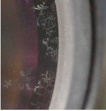
Lente con presencia de hongos.
