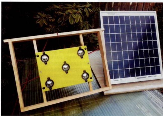
Fot. 2. Ramka ultradźwiękowa z emitern sonicznym zawierającym pięć widocznych ultradźwiękowych główek piezoelektrycznych. Widoczny po prawej stronie panel fotowoltaiczny oraz akumulator (umieszczony pod ulem) stanowią układ zasilający
