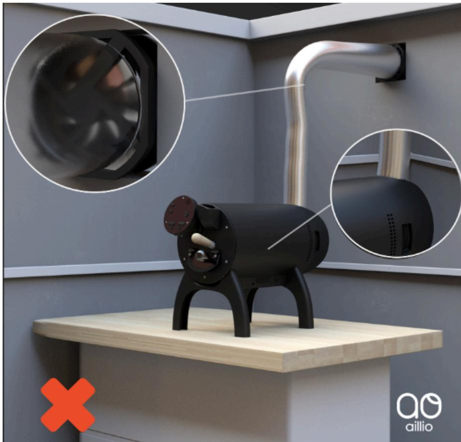
Im nächsten Beispiel kann die versiegelte, aktive (mit einem Ventilator ausgestattete) Entlüftung zu viel Luft aus dem Bullet ziehen, wenn er in Betrieb ist. Auch dies kann den Luftstrom im Bullet beeinträchtigen und zu ungleichmäßigen Röstungen führen.
