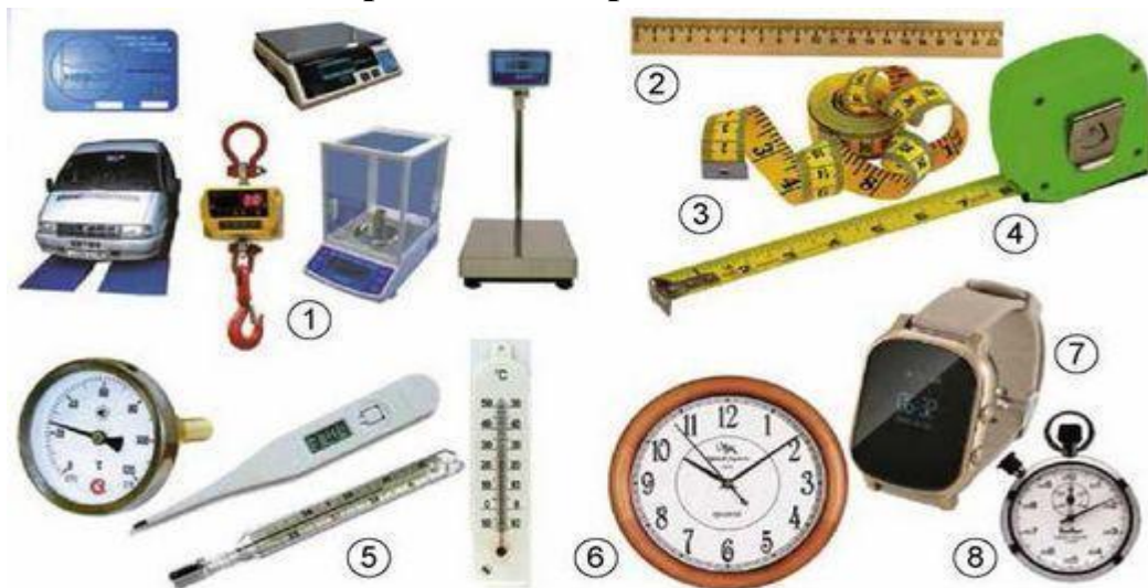
Мал. 8. Вимірювальні прилади: 1 – різні види терезів; 2 – лінійка; 3 – метр; 4 – рулетка; 5 – різні види термометрів; 6, 7 – годинники; 8 – секундомір
