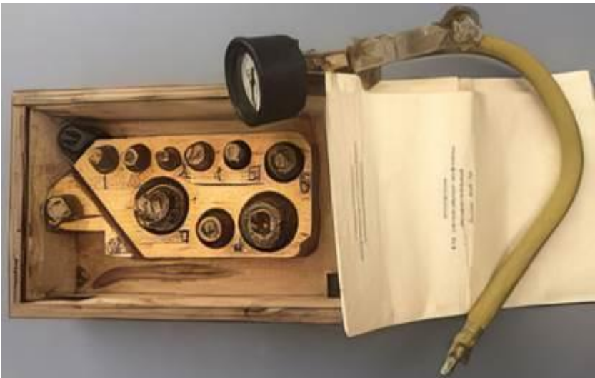
Рис. 3.14. Пристрій КИ-13936 для вимірювання тиску масла у головній масляній магістралі
