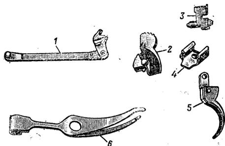
1—спусковая тяга с рычагом взвода; 2— курок; 3 — шептало с пружиной; 4 — задвижка боевой пружины; 5—спусковой крючок; 6 — боевая пружина
