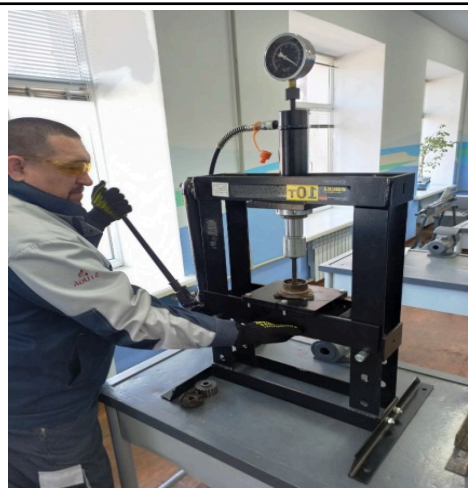
7. Випресовуємо вал водяного насосу з корпусу
