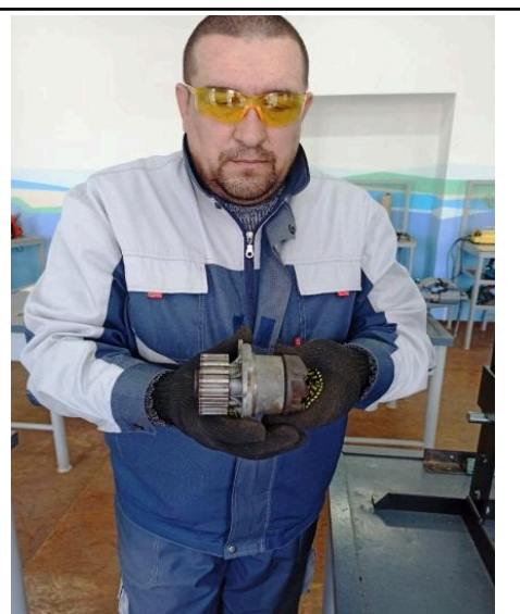
12. Крильчатка запресована на вал водяного насосу
