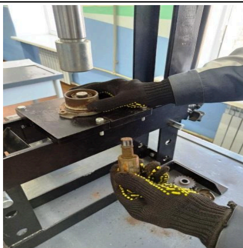
8. Випресований вал з корпусу водяного насосу
