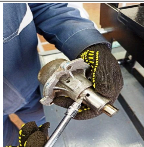
9. Поєднуємо мітки, які знаходяться на валу і корпусі водяного насосу
