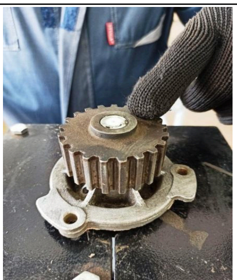
11. Через наставку запресовуємо крильчатку в корпус водяного насосу
