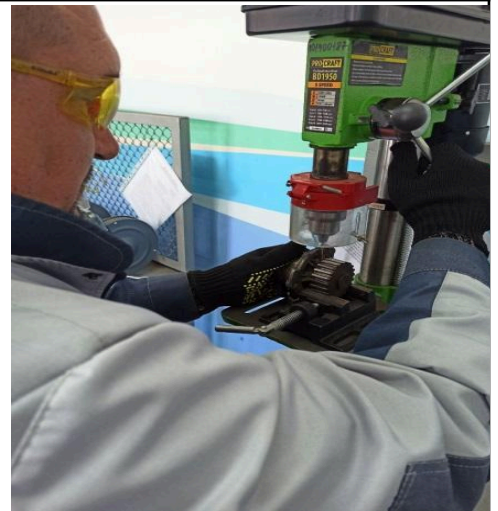
3 Висвердлюємо стопор валу водяного насосу
