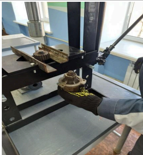
5. Відокремлений шків від водяного насосу
