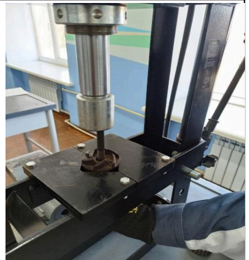
6. Випресовуємо крильчатку водяного насосу
