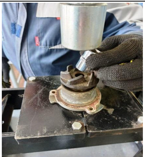
11. Через наставку запресовуємо крильчатку в корпус водяного насосу
