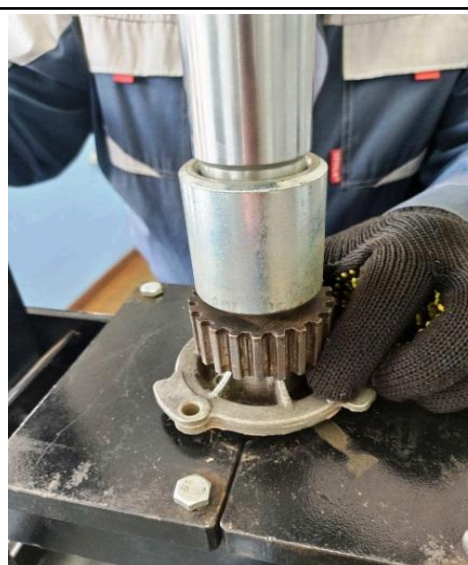
10. Запресовуємо вал в корпус водяного насосу
