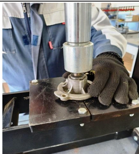
10. Запресовуємо вал в корпус водяного насосу
