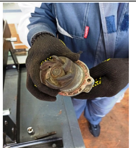
12. Крильчатка запресована на вал водяного насосу
