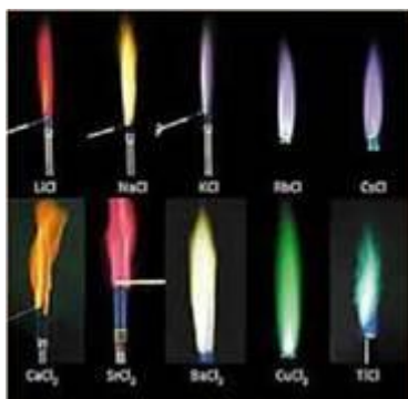
Рис. 16.3. Забарвлення полум'я хлоридами металічних елементів
