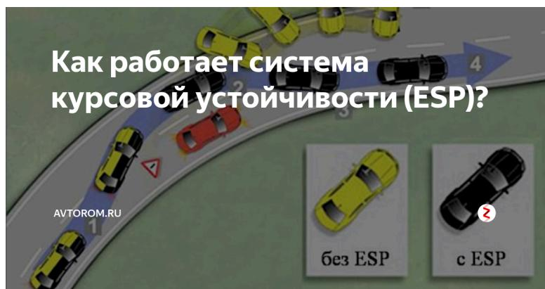
**Ответ:** Система ESP это программа ЭБУ которая состоит из программ ABS, ASR, EBD, ATTS, и объединяет их в одну общую по этим названием, позволяя автомобилю не пробуксовывать, не блокировать колеса при торможении, перераспределять крутящий момент при повороте, и тормозные усилия при торможении во время движения по дороге с неоднородным покрытием и повороте.
