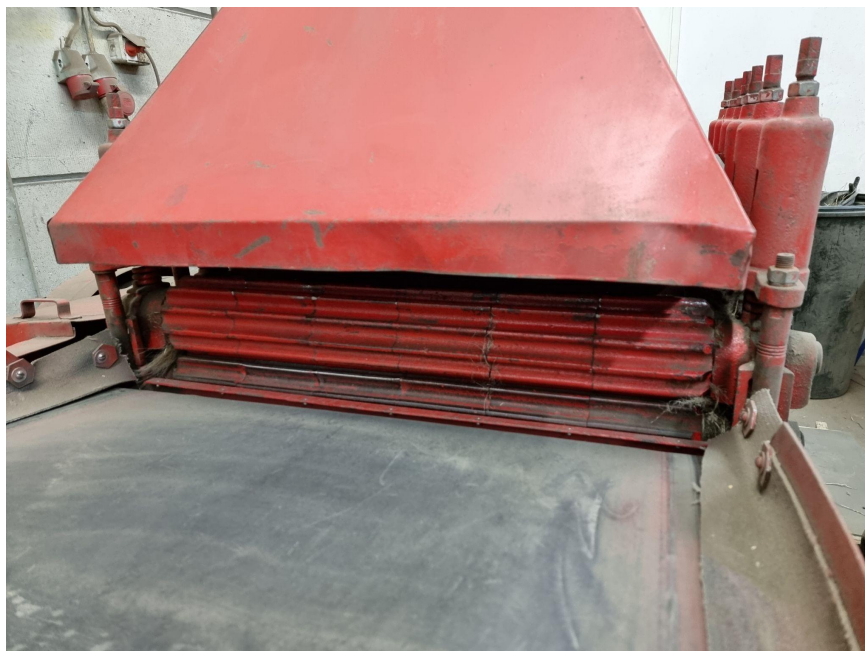
Kuva 2. Ensin loukutetaan pellavanvarsien puumaiset tukisolukot eli päästäret irti.
