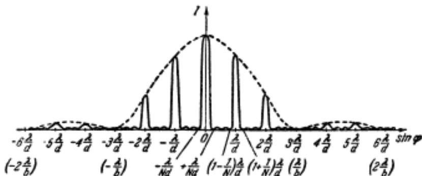
Рисунок 3 – Розподіл інтенсивності світла при дифракції від дифракційної решітки
