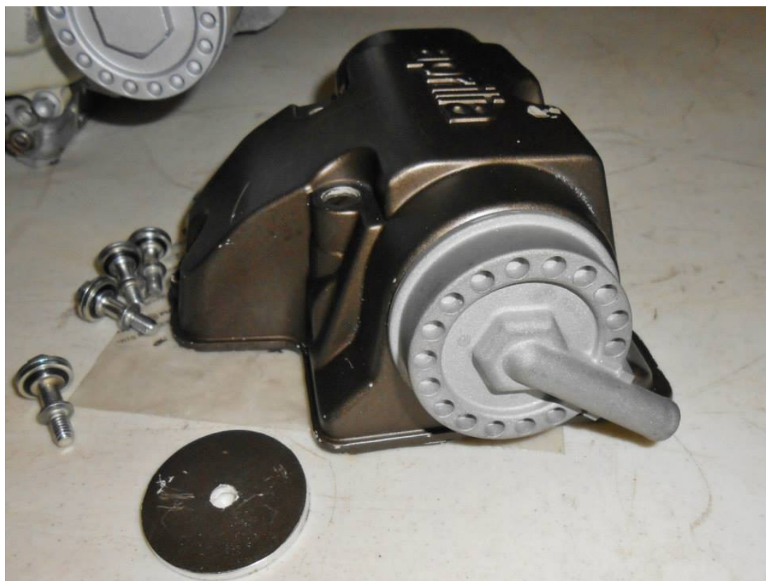
Hátsó henger szelepfedél extra kartergáz szellőző (MXV gyárilag ilyen):
