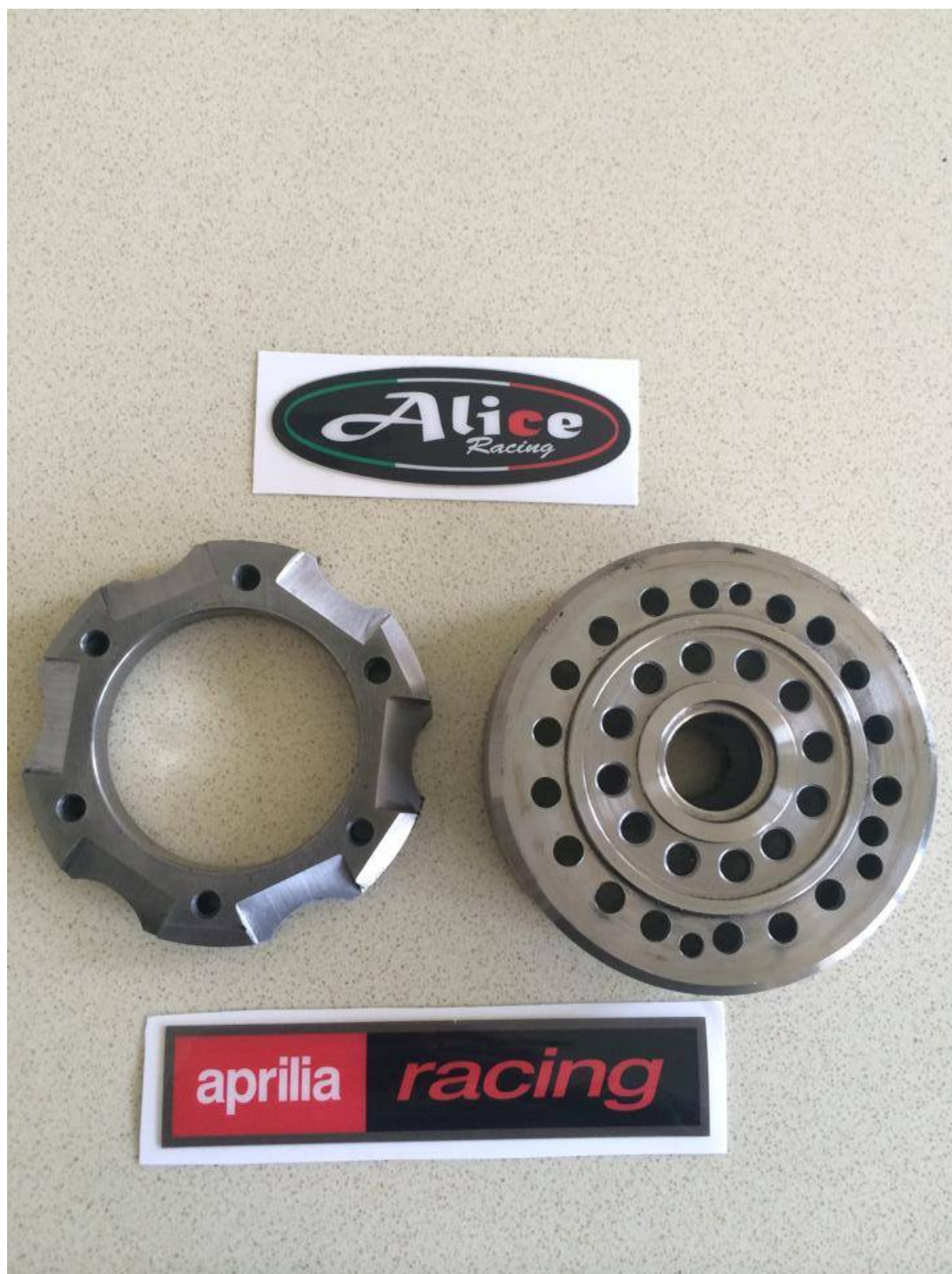
Alumínium kuplung lamella szett (Alice Racing):
