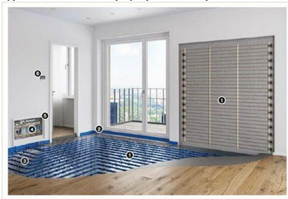
Рисунок 4 - Элементы панельного отопления: 1) греющие трубы; 2) краевая изоляция; 3) тепловая изоляция и гидроизоляция; 4) распределитель теплоносителя подпольного отопления; 5) монтажный шкафчик; 6) регулятор температуры
