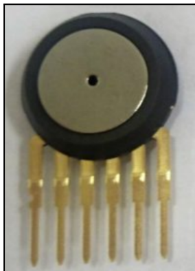
MPX4115A-paineanturi | Piikkirima (uroslitittä) 2 x 32-nastainen | Vastukset 1x 75 Ohm 1x 10 kOhm
