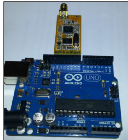
Lähetin-vastaanottimen kytkeminen Arduino Uno-piirilevyyn ( kuva isompana )
