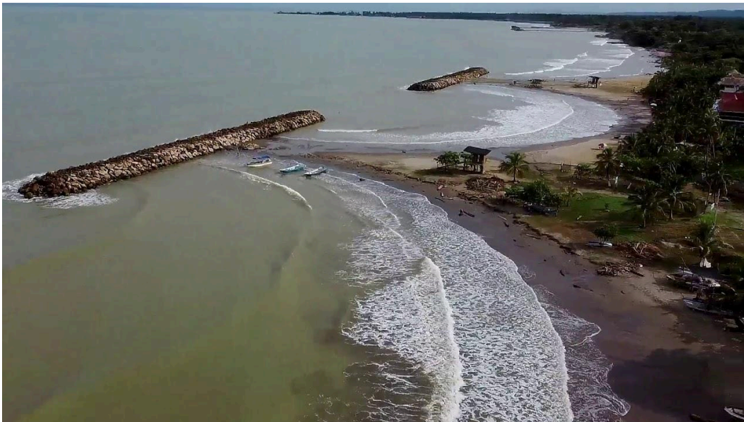
Figura 8: Aplicación del fenómeno de difracción en playas.
